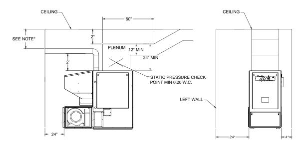
EVEN IF THE REQUIRED CLEARANCES ARE 24" FOR MAINTENANCE, WE RECOMMEND 30" IN ORDER TO FACILITATE MAINTENANCE OF THE FURNACE.
